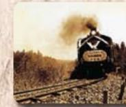
国鉄C11形蒸気機関車は、日本国有鉄道(国鉄)の前身である鉄道省が製造した過熱式のタンク式蒸気機関車です。Cのチョンチョンという愛称で呼ばれています。国を代表する蒸気機関車の一つであるC11形は廃車後、全国各地で静態保存となり野辺地でも保存されています。
